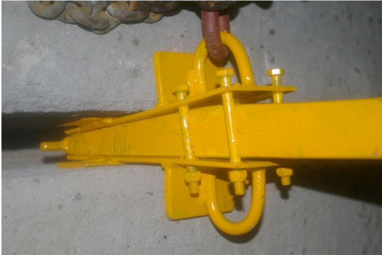
Figur 8. SB-liv efter test tvärs HDF-skarv
