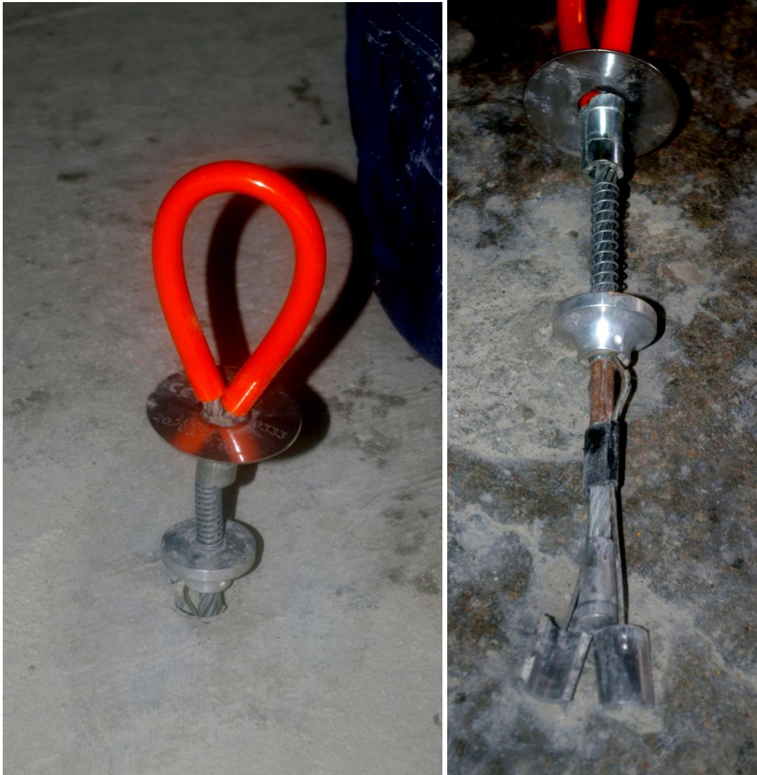
Figur 6. Quick-lock i 18 mm hål före och efter test
