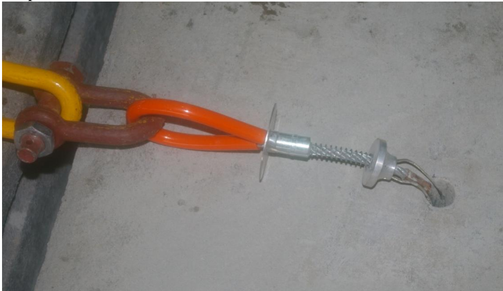
Figur 5. Quick-lock efter test i 16 mm hål
